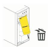
Inclinare la testa del filtro in avanti, ruotare la cartuccia filtrante di circa 90 gradi in senso antiorario e tirarlo verso il basso. Questo lo sbloccherà dalla testa del filtro per consentirne la rimozione.
