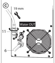
Collegare l'adattatore dello stelo (11) al fine del collegamento idrico (C) al CCU ("Water OUT") e serrarlo.
