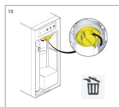
Inclinare la testa del filtro in avanti, ruotare la tazza di pulizia di circa 90 gradi antiorario e tirarlo verso il basso. Questo sbloccherà la testa del filtro per abilitarlo alla rimozione.
