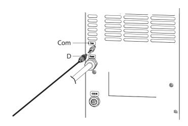
Collegare il cavo di comunicazione (D) del rubinetto al CCU (connessione «Com»)
