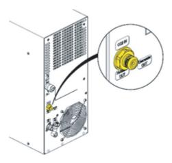
Il riduttore di pressione esterno per la bombola di CO2 deve essere regolata su 5 bar. La pressione in ingresso sul sistema CCU non deve mai superare 6 bar. Per un approvvigionamento esterno alternativo di CO2, collegare il tubo da 3/16" con riduttore di pressione al CCU (connessione "CO2 IN").
